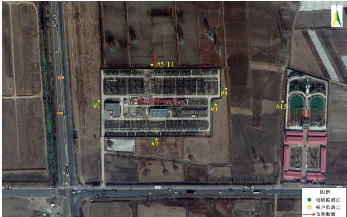
图5 石各庄 220kV 变电站及敏感目标监测布点图
